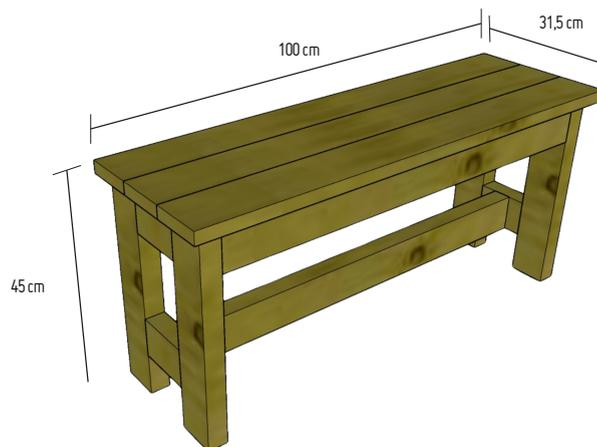
Las tablas A se aseguran con 24 tornillos de 2" sobre la base de la banca.
